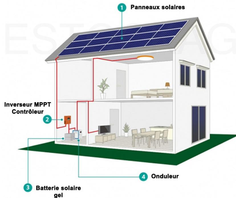
Ce kit solaire est prévu pour une consommation de 20 kWh par jour. Livré avec 20 panneaux solaires (fixation toit incluse) de 250 w garantie 25 ans, 1 contrôleur, 1 onduleur, 8 batteries de 250 AH, 6 paires de connecteur, 1 boîtier de jonction protégeant des surtensions et 50+40 mètres de câble.
